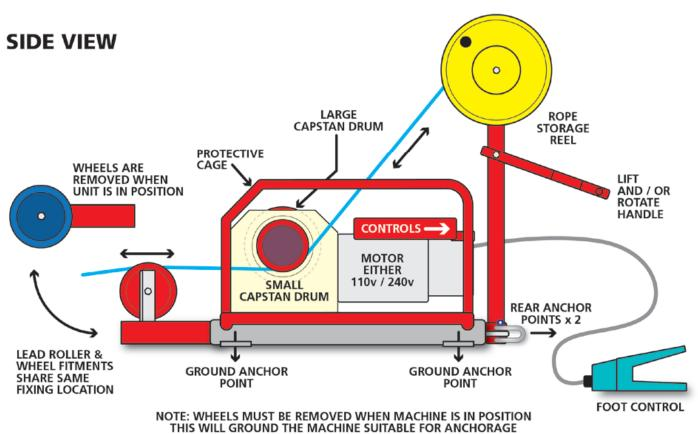
BEFORE ANY OPERATION USING CABLE-PULLER, THE UNIT MUST BE SECURELY ANCHORED. FAILURE TO
