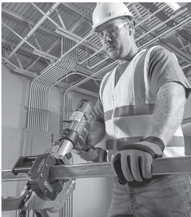
Figure 8 – Cisaille en cours d'opération
