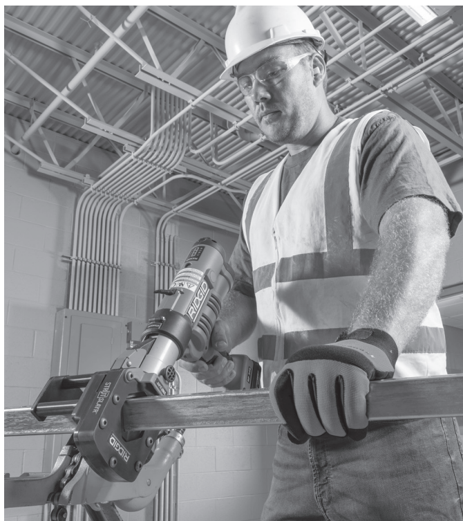
Figura 8 – Uso del cabezal de corte por cizalla
